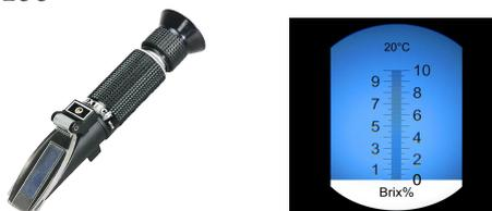
A l'aide d'un réfractomètre on contrôle la densité en % Brix.
